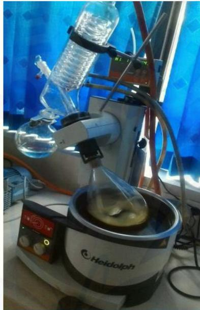
**Gambar 3.1** Menguapkan etanol menggunakan *Rotary evaporator* (dokumentasi pribadi)
