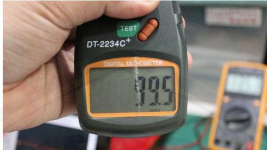
Gambar 7. Hasil pengujian kecepatan motor *brushless direct current* (bldc) menggunakan Tachometer pada frekuensi 10 Hz
