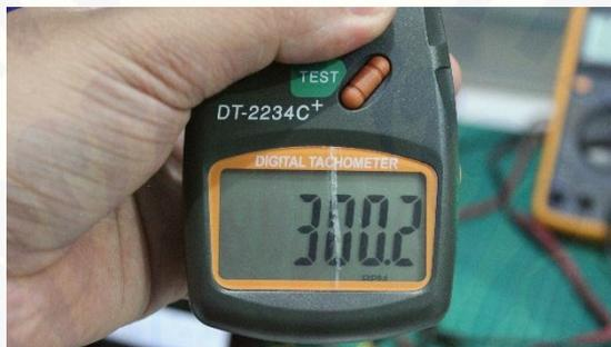
Gambar 11. Hasil pengujian kecepatan motor *brushless direct current* (bldc) menggunakan Tachometer pada frekuensi 30 Hz
