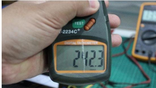
Gambar 10. Hasil pengujian kecepatan motor *brushless direct current* (bldc) menggunakan Tachometer pada frekuensi 25 Hz
