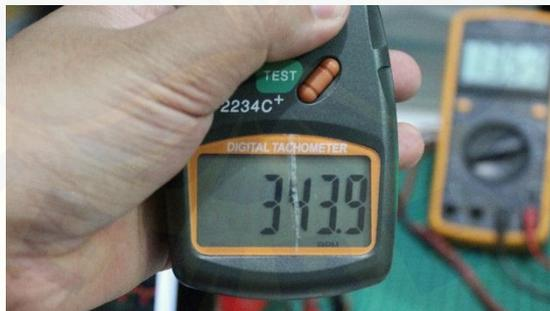
Gambar 12. Hasil pengujian kecepatan motor *brushless direct current* (bldc) menggunakan Tachometer pada frekuensi 35 Hz
