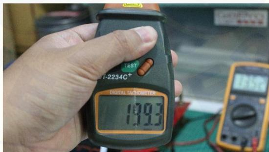
Gambar 9. Hasil pengujian kecepatan motor *brushless direct current* (bldc) menggunakan Tachometer pada frekuensi 20 Hz
