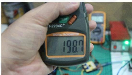
Gambar 3. Hasil pengujian kecepatan motor *brushless direct current* (bldc) menggunakan Tachometer pada frekuensi 20 Hz
