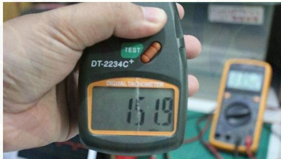
Gambar 8. Hasil pengujian kecepatan motor *brushless direct current* (bldc) menggunakan Tachometer pada frekuensi 15 Hz
