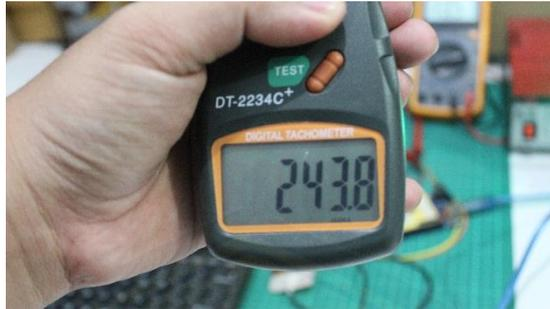
Gambar 4. Hasil pengujian kecepatan motor *brushless direct current* (bldc) menggunakan Tachometer pada frekuensi 25 Hz
