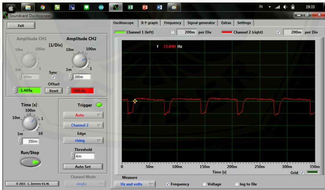
Gambar 14. Hasil nilai frekuensi motor *brushless direct current* (bldc) menggunakan *oscilloscope* pada frekuensi 15 Hz
