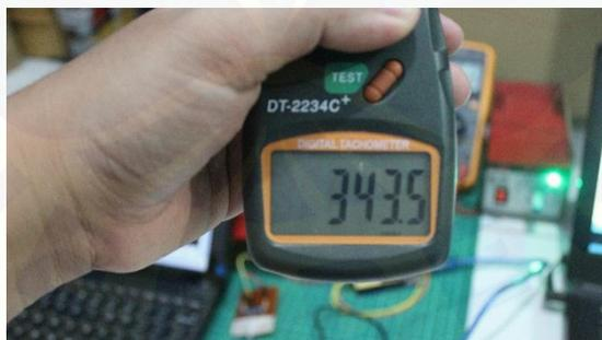
Gambar 6. Hasil pengujian kecepatan motor *brushless direct current* (bldc) menggunakan Tachometer pada frekuensi 35 Hz
