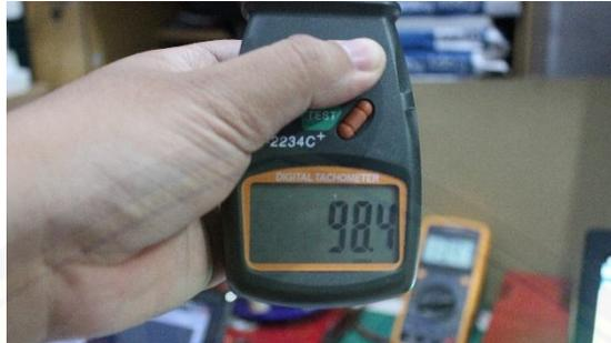
Gambar 1. Hasil pengujian kecepatan motor *brushless direct current* (bldc) menggunakan Tachometer pada frekuensi 10 Hz
