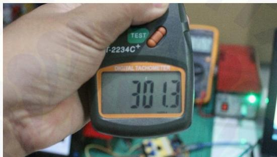
Gambar 5. Hasil pengujian kecepatan motor *brushless direct current* (bldc) menggunakan Tachometer pada frekuensi 30 Hz
