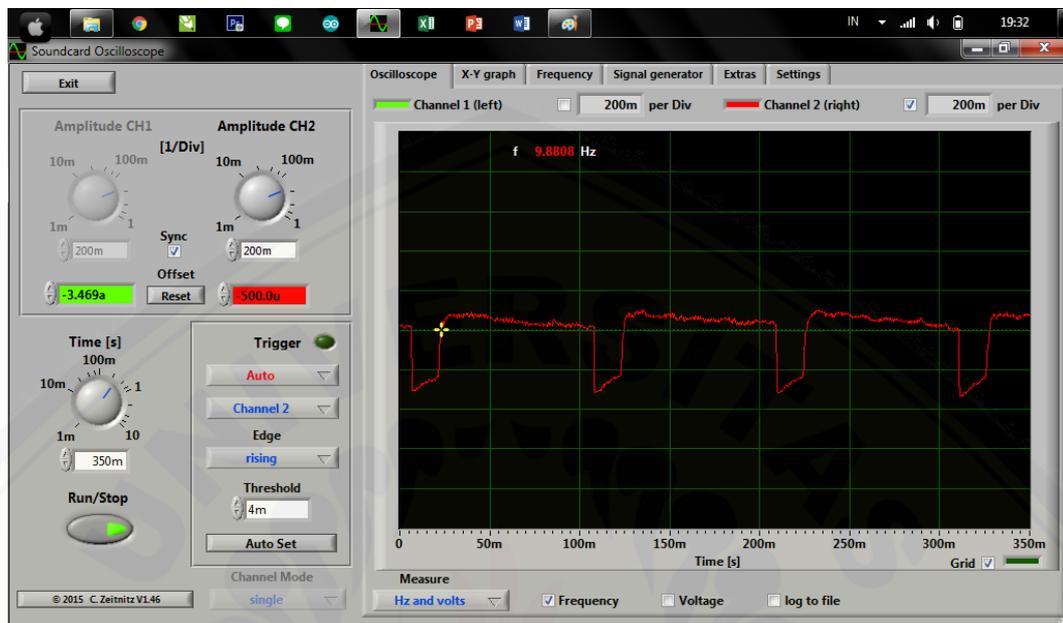
Gambar 13. Hasil nilai frekuensi motor *brushless direct current* (bldc) menggunakan *oscilloscope* pada frekuensi 10 Hz
