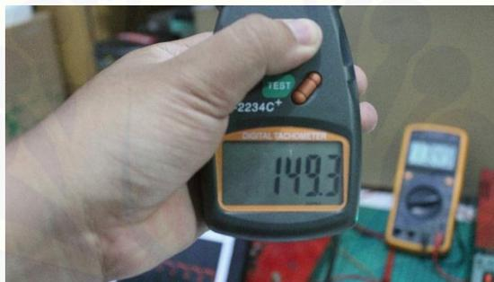
Gambar 2. Hasil pengujian kecepatan motor *brushless direct current* (bldc) menggunakan Tachometer pada frekuensi 15 Hz
