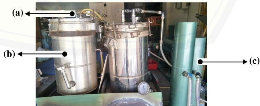
(a) Kondensor; (b) Tabung destilasi; (c) Tabung pendingin
