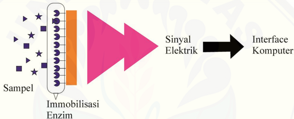
Gambar 2.3 Skematis prinsip kerja enzim biosensor (Kuswandi, 2010)
