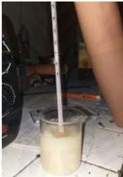
Gambar lampiran h). Pengukuran titik leleh PCM
