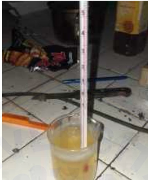
Gambar lampiran i). Pengukuran suhu leleh menyeluruh PCM
