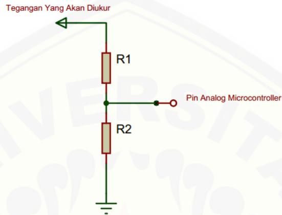
Gambar 2.5 Sensor Tengan Dengan Konsep Pembagi Tegangan
