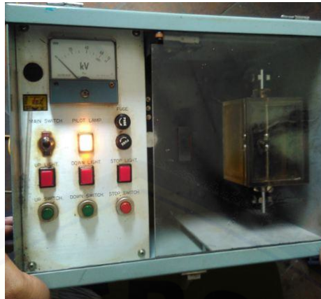
Gambar 4.18 Pengujian Tegangan Tembus pada minyak transformator 3
