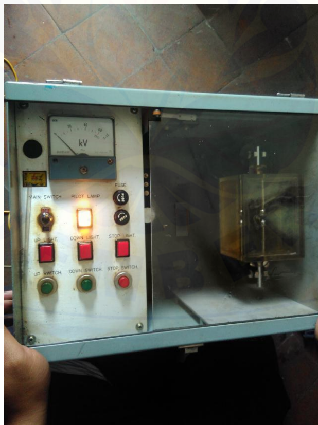
Gambar Proses Pengujian Tegangan Tembus
