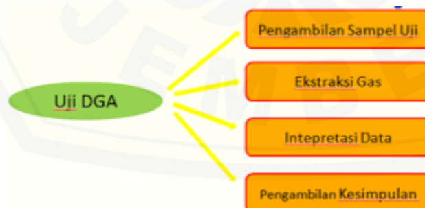
Gambar 2.10 Langkah Pengujian DGA ( Sumber : Muhammad Faishal, 2011 )
