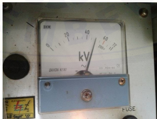
Gambar 4.16 Hasil Uji Tegangan Tembus Transformator 1
