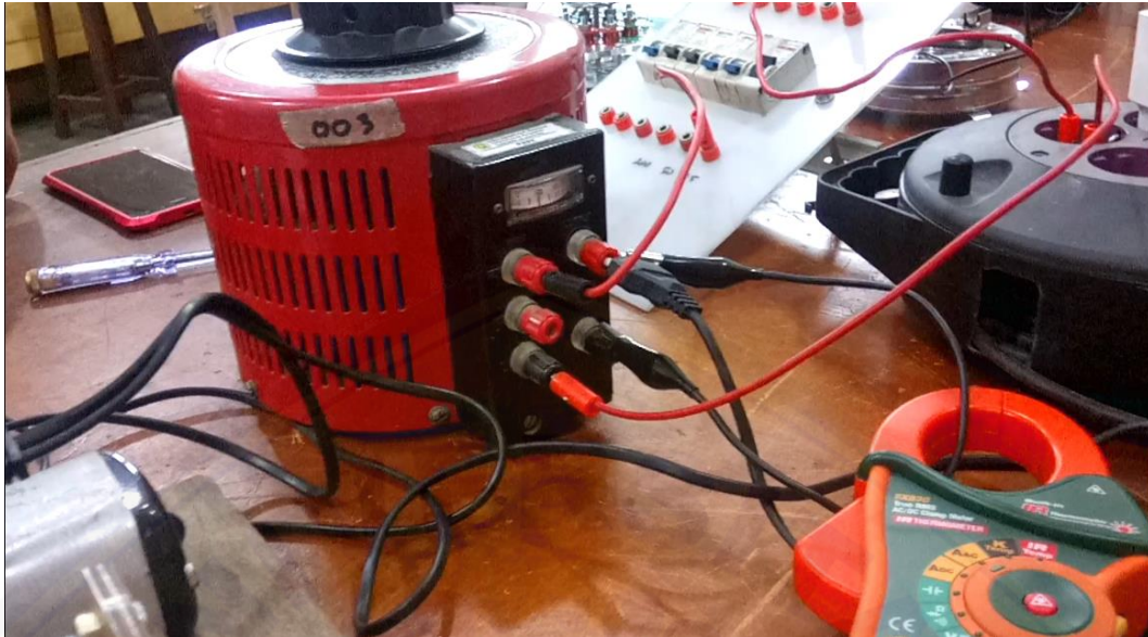
Gambar 3. Pengujian Generator Axial Flux Tegangan Output 28 V
