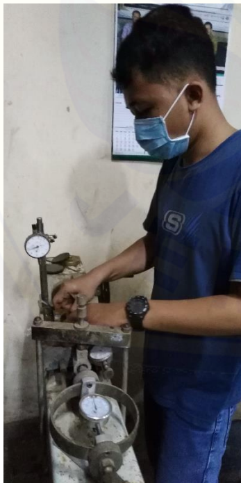
Gambar 3. Pengujian sudut geser dan kohesi tanah dengan alat direct shear
