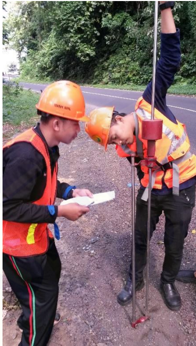
Gambar 1. Pengambilan data CBR dengan alat DCP
