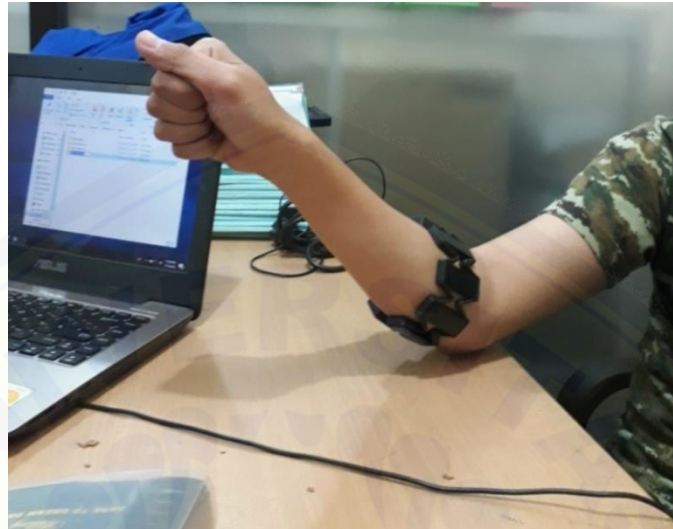
Gambar 3.11 Letak Perangkat Myo Armband pada Tangan
