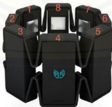
Gambar 2.4 Posisi channel EMG pada perangkat Myo Armband (Adi,2017)
