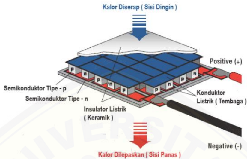
Gambar 2.10 Prinsip kerja elemen Peltier (Sumber: Kusumah, 2014)
