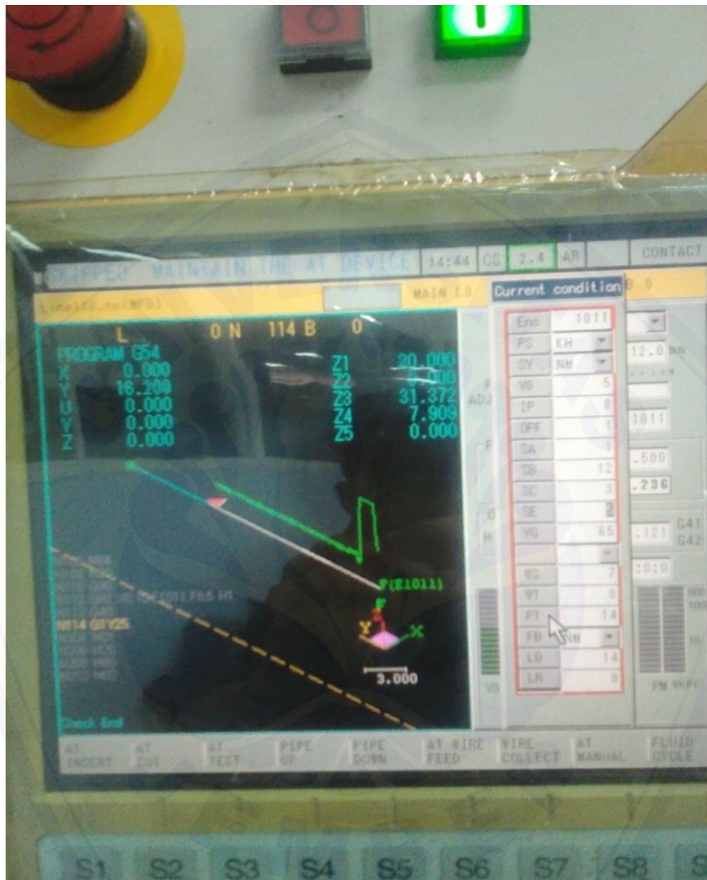
Lampiran 6.4 parameter Wire cut edm mistubishi BA8
