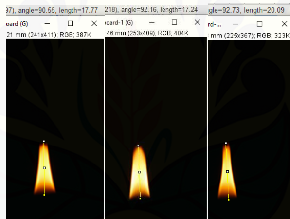
Gambar B1.10 Tinggi api berturut-turut adalah 1,77 cm, 1,72 cm, 2,00 cm
