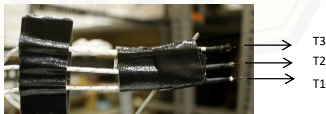
Gambar 3.2 Posisi termokopel saat pengujian (Sumber: dokumen pribadi)
