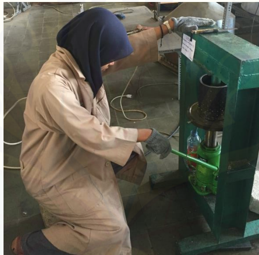
Gambar 2 Ekstraksi kemiri menggunakan press hidrolis
