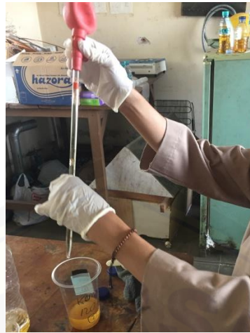
Gambar 4 Proses pemisahan biodiesel terhadap gliserol
