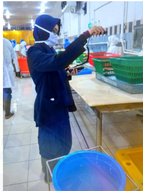
Gambar 5. Mengukur Nilai Reflektan pada Meja
