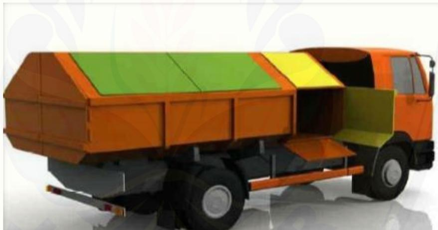
Gambar 2.5. *Arm roll Truck* kapasitas  $9 \text{ m}^3$
