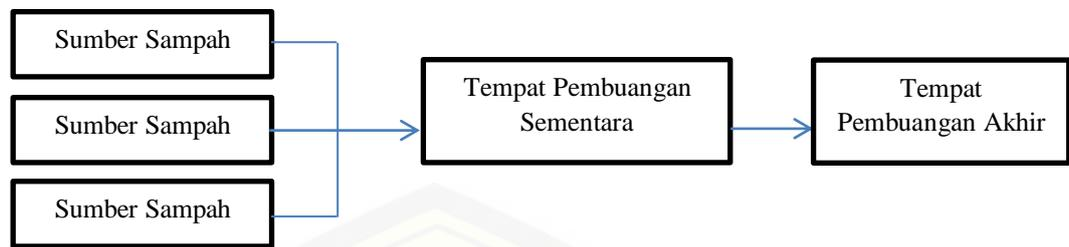
Gambar 2.3. Sistem pengumpulan sampah secara tidak langsung
