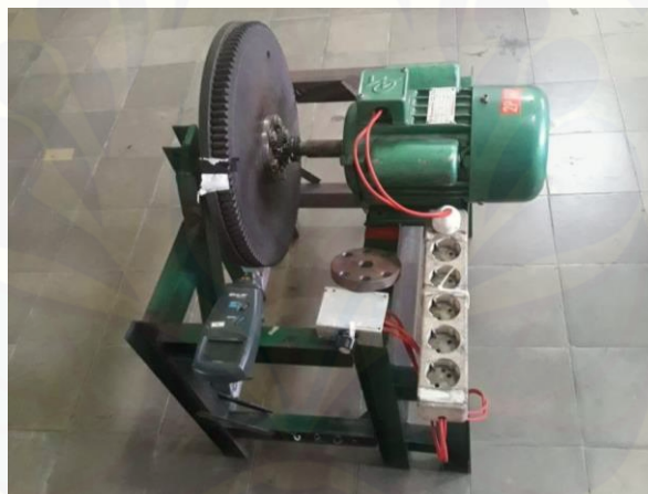
Gambar C.2 Alat uji rolling resistance untuk bearing
