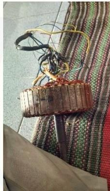
Gambar 2. Proses Peleburan Varnish pada Motor BLDC
