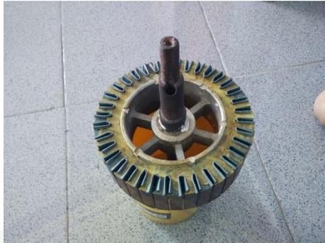
Gambar 4. Hasil Pemasangan Isolator pada Motor BLDC
