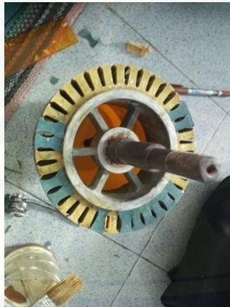
Gambar 3. Proses Penambahan Isolator dengan menggunakan kertas Pripsan
