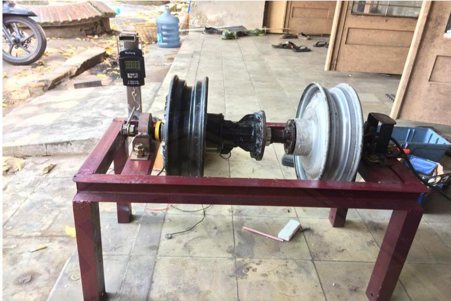
Gambar 3.5 Pengujian Karakteristik Motor BLDC
