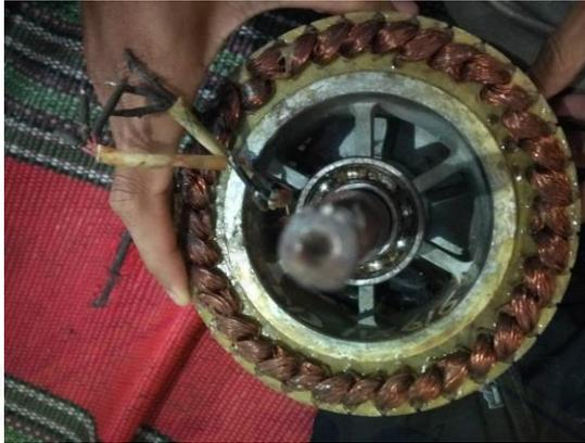
Gambar 1. Pembongkaran skema Motor BLDC
