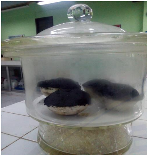
Gambar 13. Desikator untuk pengurangan kadar air
