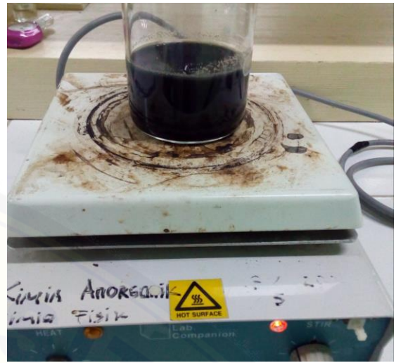
Gambar 14. Pengadukan dengan Magnetic Stirrer dengan 400 rpm
