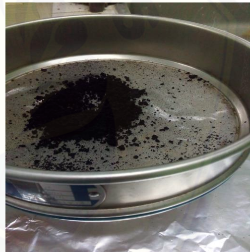
Gambar 8. Pengayakan biji kelor dengan menggunakan ayakan berukuran 100 mesh
