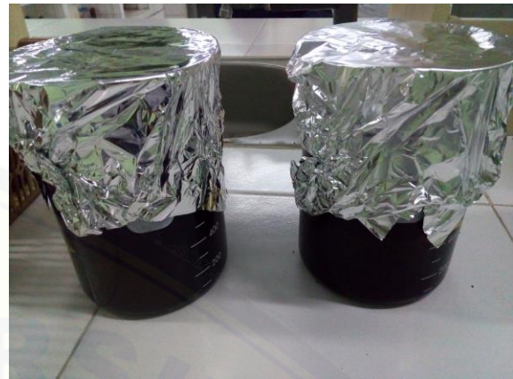
Gambar 10. Proses aktivasi dengan HCL 0,1 M
