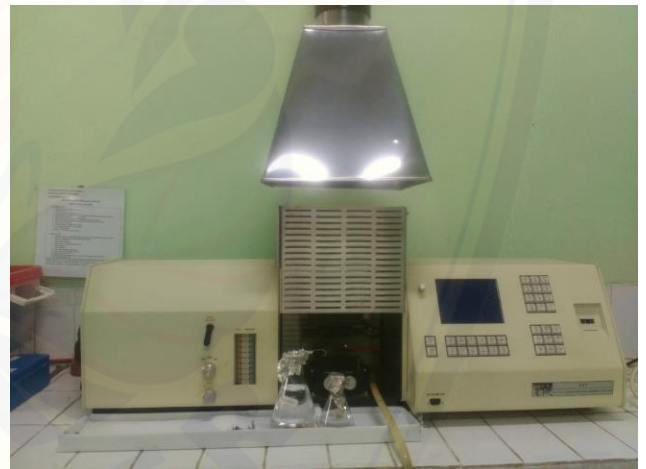
Gambar 16. Pengujian kadar kadmium (Cd) dengan SSA
