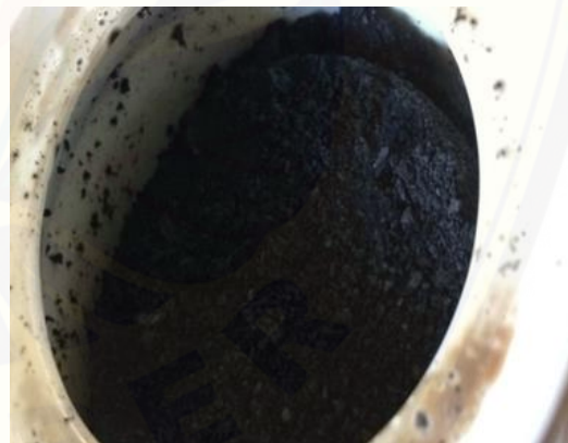
Gambar 8. Arang Kulit Pisang pisang di masuk kan kedalam furnane
