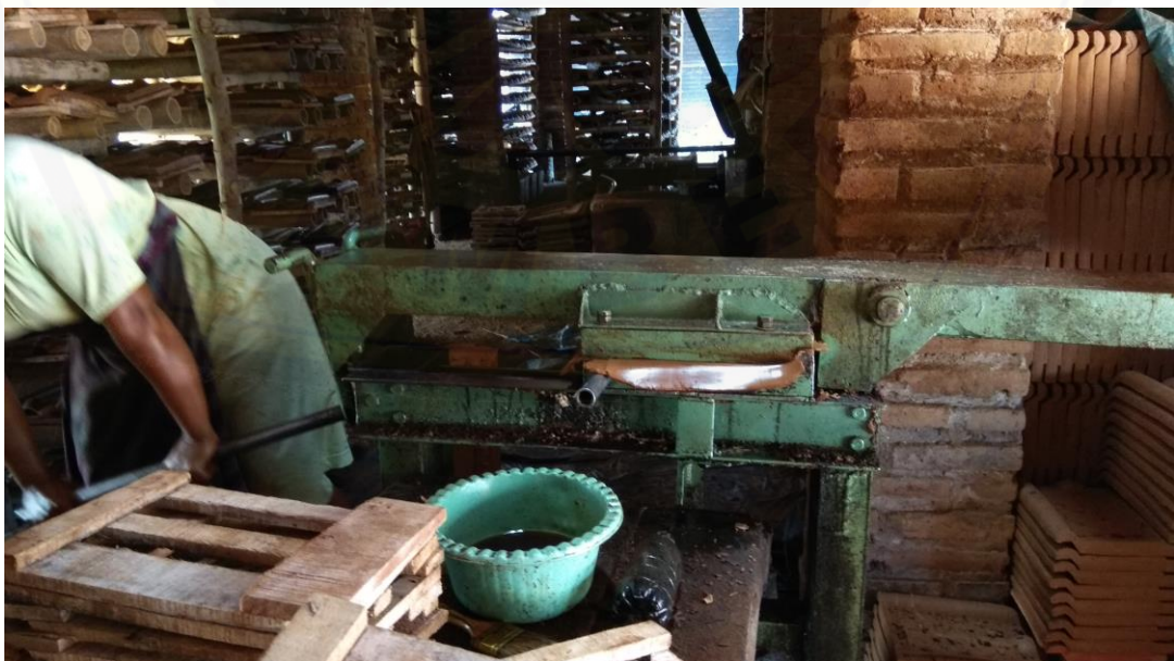
Proses Pencetakan Genteng dengan Alat Press
