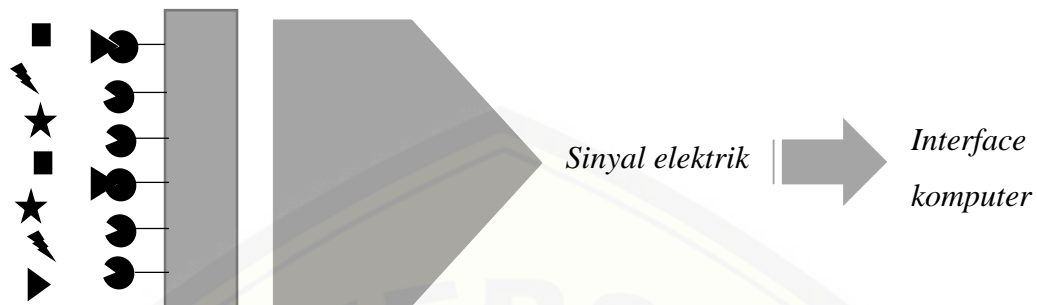
Gambar 2.2 Skema prinsip kerja enzim biosensor (Kuswandi, 2010)
