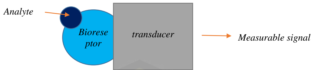
Gambar 2.1 Skema kerja biosensor (Kuswandi, 2010)
