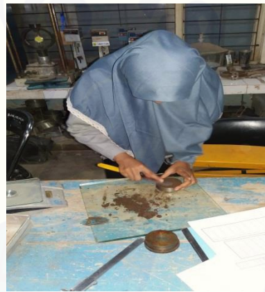
Gambar 6 Pengujian Berat Isi Tanah
