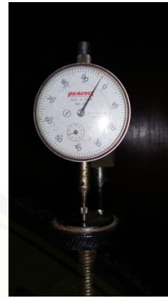
Gambar 4 Pengujian Konsolidasi Tanah
