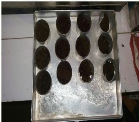
Gambar 5 Pengujian Kadar Air Tanah
