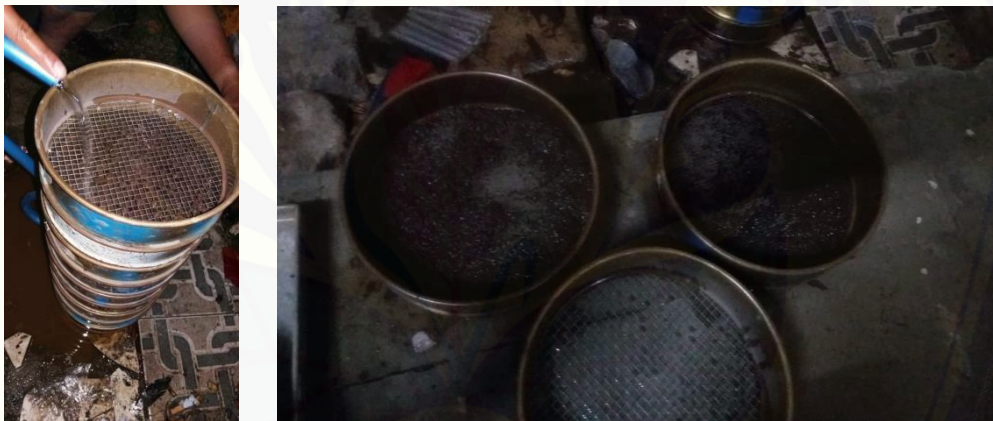
Gambar 2 Pengujian Analisa Saringan Basah
