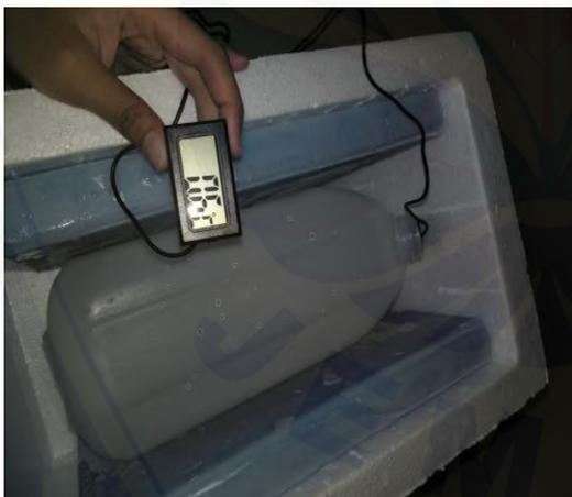
Pengawetan Sampel Air Limbah AF dan Memantau Suhu Menggunakan Termometer Air Digital.
