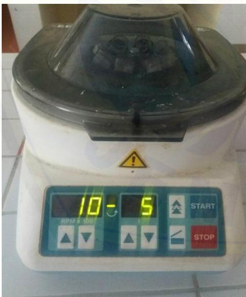
Gambar 3. Tabung diputar selama 5 menit dengan kecepatan 1000 RPM
