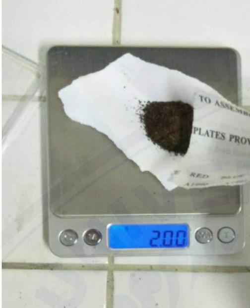
Gambar 1. Pengukuran 2 gram sampel tanah yang akan diperiksa
