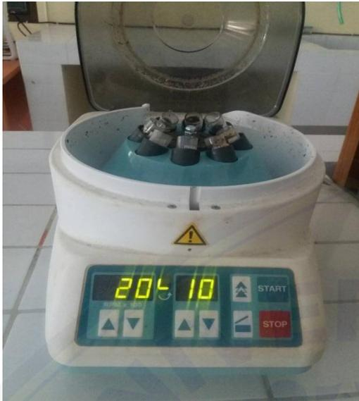
Gambar 5. Tabung diputar selama 10 menit dengan kecepatan 2000 RPM
