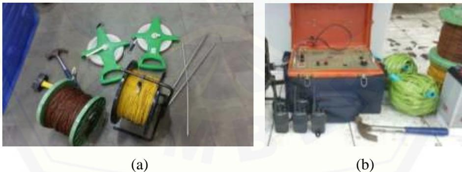
Gambar 3.3 Peralatan Geolistrik, (a) Kabel gulung, meteran, elektroda dan palu; (b) Alat geolistrik, *hand-talking*, aki basah dan tali raffia.
