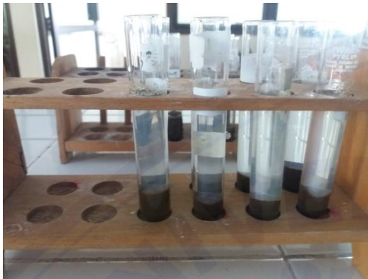
Gambar 5. Supernatan dalam tabung centrifuge dibuang lalu ditambahkan MgSO_4 8 mL.
