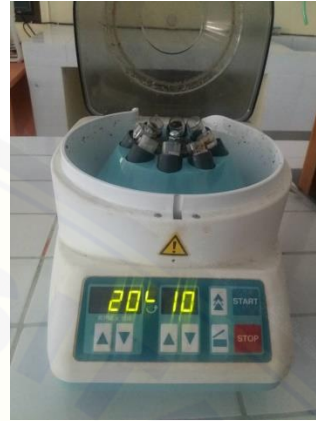
Gambar 6. Tabung centrifuge dipusingkan kembali dengan kecepatan 2000 rpm selama 10 menit.
