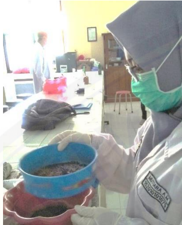
Gambar 1. Pengayakan tanah dengan saringan 150 \mu m.
