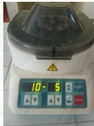
Gambar 4. Memusingkan tabung centrifuge dengan kecepatan 1000 rpm selama 5 menit
