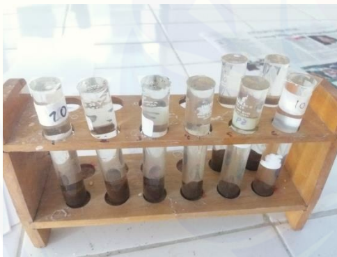
Gambar 7. Pada tabung centrifuge ditambahkan MgSO_4 sampai terbentuk meniskus cembung dan kemudian ditutup dengan kaca penutup selama 10 menit.
