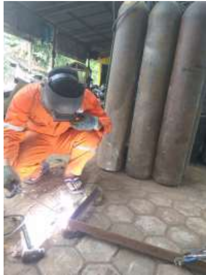
Gambar C.4 Proses pengelasan besi L sebagai rangka
