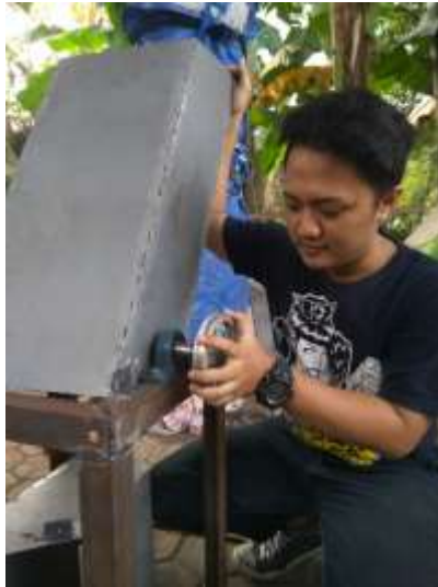
Gambar C.6 Proses pemasangan pulley
