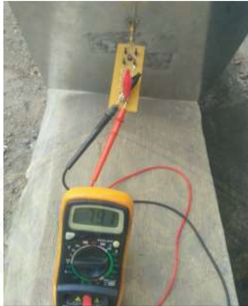
Gambar 20 Hasil Tegangan DC 200 m Menggunakan Rangkaian Match
