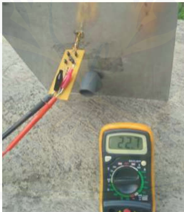
Gambar 21 Hasil Tegangan DC 300 m Menggunakan Rangkaian Match
