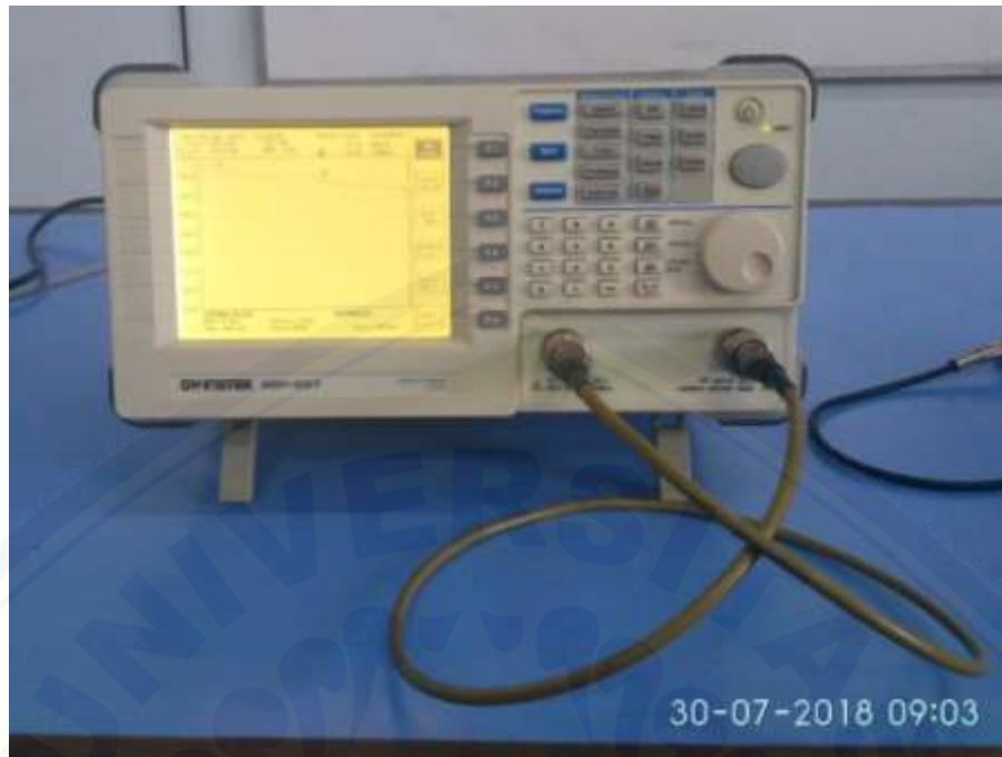
Gambar 8 Proses Pengujian Level Referensi
