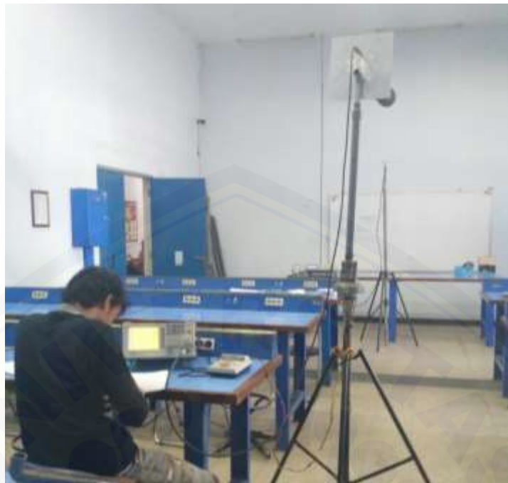
Gambar 11 Proses Pengukuran Gain dan Pola radiasi
