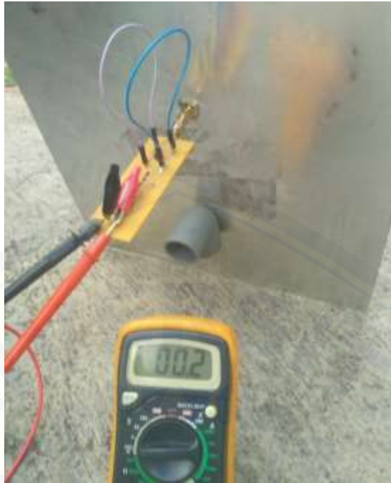
Gambar 24 Hasil Tegangan DC 300 m Tanpa Rangkaian Matching
