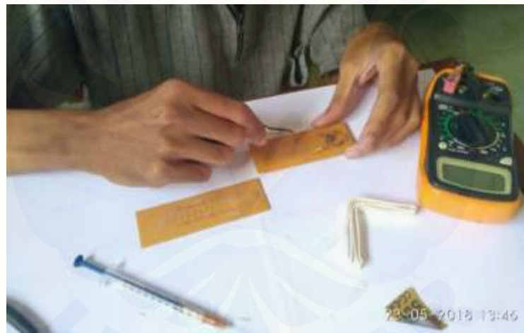
Gambar 4 Proses Perakitan Komponen Rectifier Cockroft-Walton
