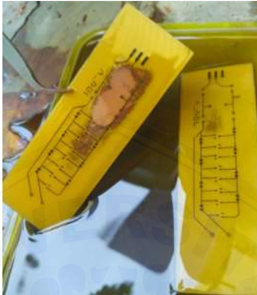
Gambar 3 Proses Pembuatan PCB Rectifier Cockroft-Walton
