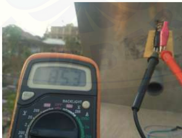
Gambar 19 Hasil Tegangan DC 100 m Menggunakan Rangkaian Matching
