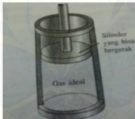
Gambar 2.2. Gas ideal di dalam silinder yang ditutup dengan piston yang bisa bergerak
