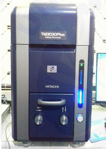
Lampiran 4.6 Mesin Uji SEM merek Hitachi tipe 3030 Plus dan Gambar Potongan Bahan untuk Uji SEM
