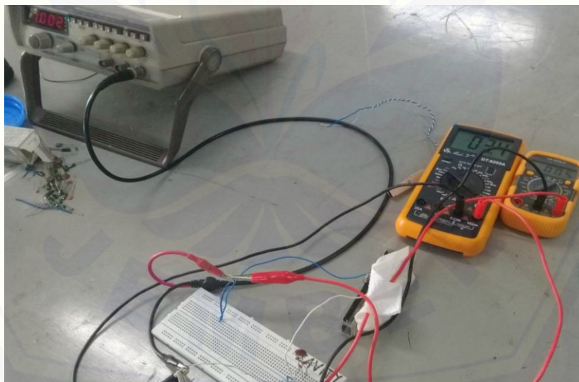
Gambar 4.7.8 Pengukuran nilai konstanta dielektrik aquades pada frekuensi 1 kHz menggunakan voltmeter
