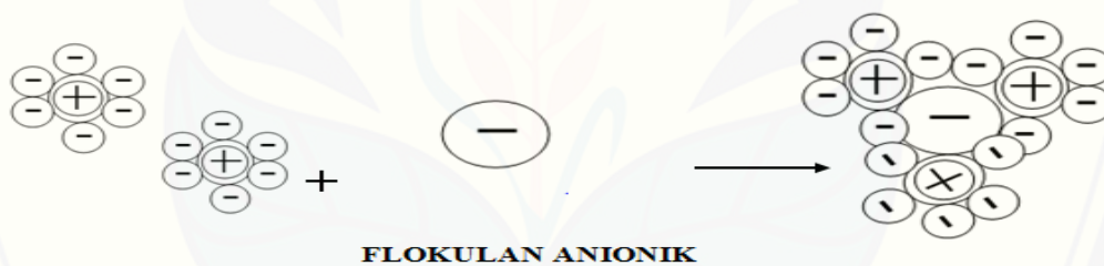
Gambar 2.3 Interaksi antar inti-inti endapan dan flokulan (Penindo dalam Azamia, 2012)
