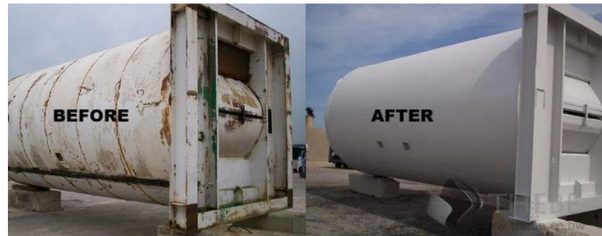
Gambar 2.1 Hasil proses sandblasting (a) sebelum dan (b) sesudah
