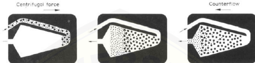
Gambar 1.6 Prinsip dari elutriasi sentrifugasi (Burdon et al , 1988)
