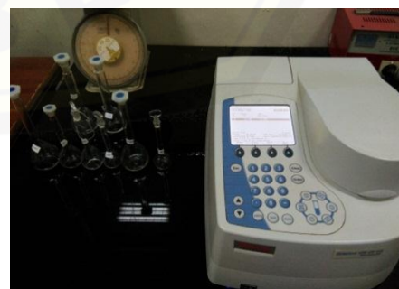
Uji keseragaman kandungan menggunakan spektrofometer UV-Vis
