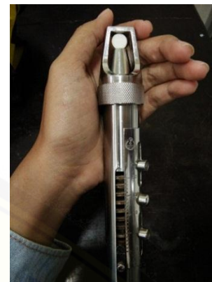
Uji kekerasan tablet menggunakan alat hardness tester
