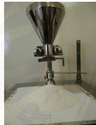
Uji kecepatan alir menggunakan alat bentuk corong
