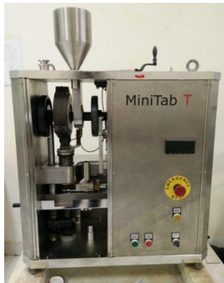
Proses tabletasi menggunakan alat Minitab-T
