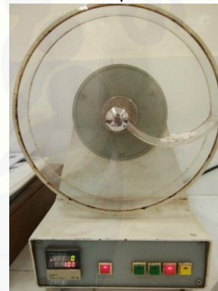
Uji kerapuhan menggunakan alat friability tester
