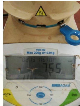
Uji kadar lembap menggunakan alat Moisture Analyze PMB 202
