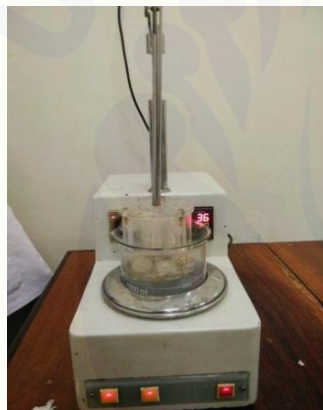
Uji waktu hancur menggunakan alat disintegration tester
