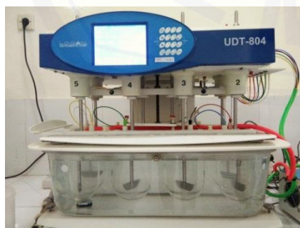
Uji disolusi menggunakan alat disolusi tipe dayung
