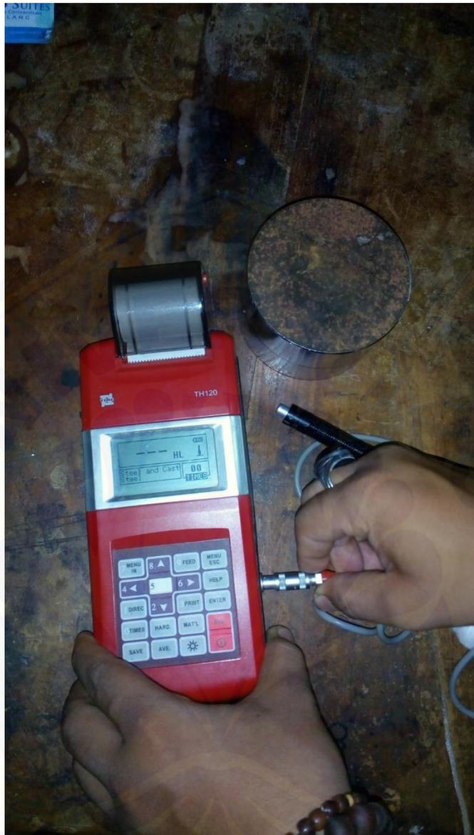
Gambar C.3 Alat Uji Kekerasan
