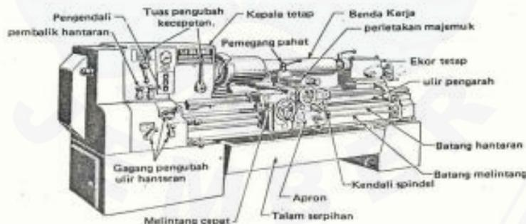
Gambar 2.3 Bagian-bagian mesin bubut (Bintaka, 2013)
