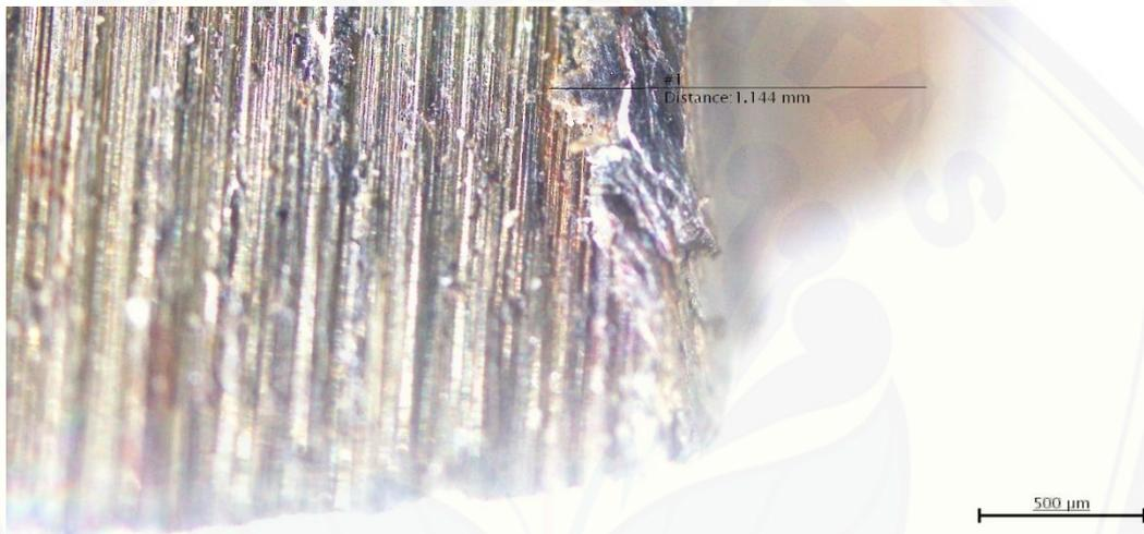
Gambar E.3 Hasil Keausan Pahat Tertinggi dengan Nilai 1.144 mm
