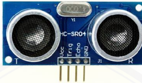
Gambar 2.4 Bentuk Fisik Sensor Ultrasonik HC-SR04
