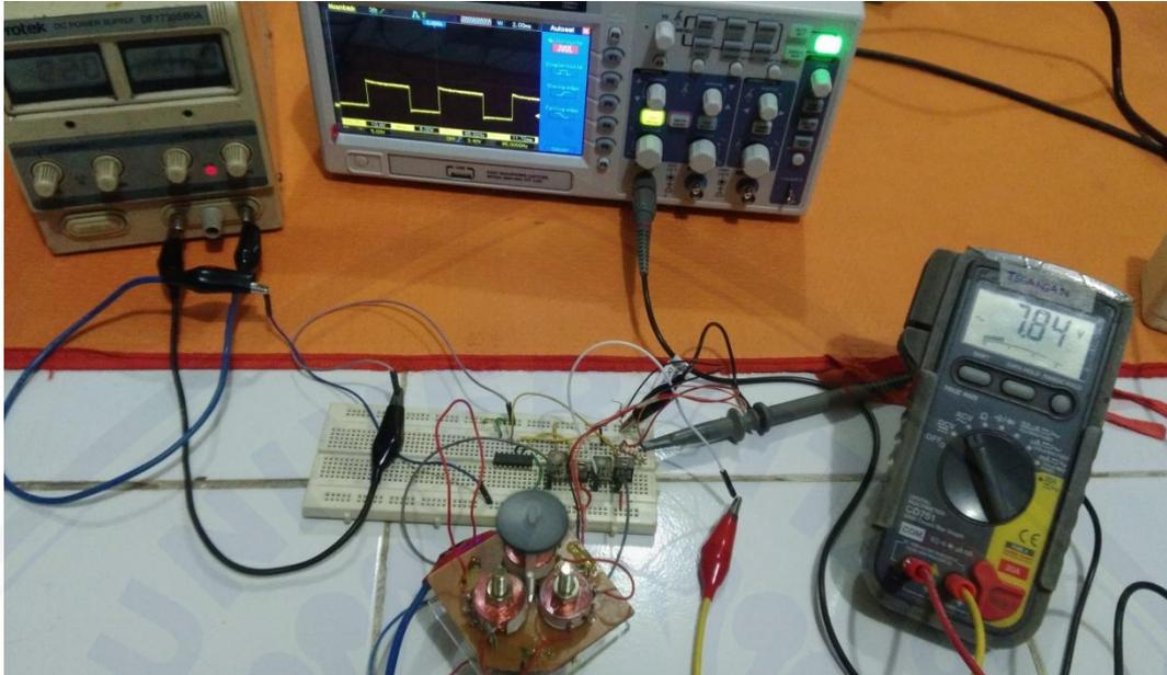
Gambar 11. Pengukuran Tegangan *Output*, Arus dan Frekuensi Pada Tegangan *Input* 6 Volt Dengan 300 Lilitan
