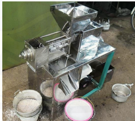
Gambar 2.2 Mesin pemeras parutan jahe dan kelapa (Sumber: http://www.madanitec.com )
