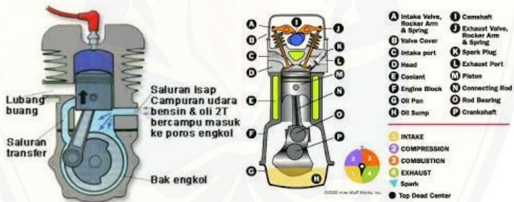
Gambar 2.4 Motor 2 langkah dan 4 langkah (Sumber : IecLtd.co.uk,2004)
