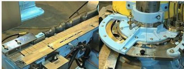
Gambar conveyor sebelum proses pentupan kaleng
