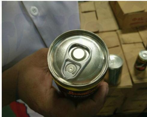
Gambar 2.15 Cacat kembung
