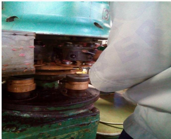
Gambar pemberian pelumas ke mesin penutup kaleng atau *seamer*
