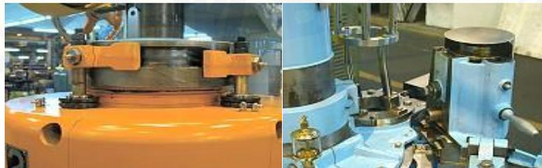
Gambar knockout cam set screw dan tempat penutup kaleng
