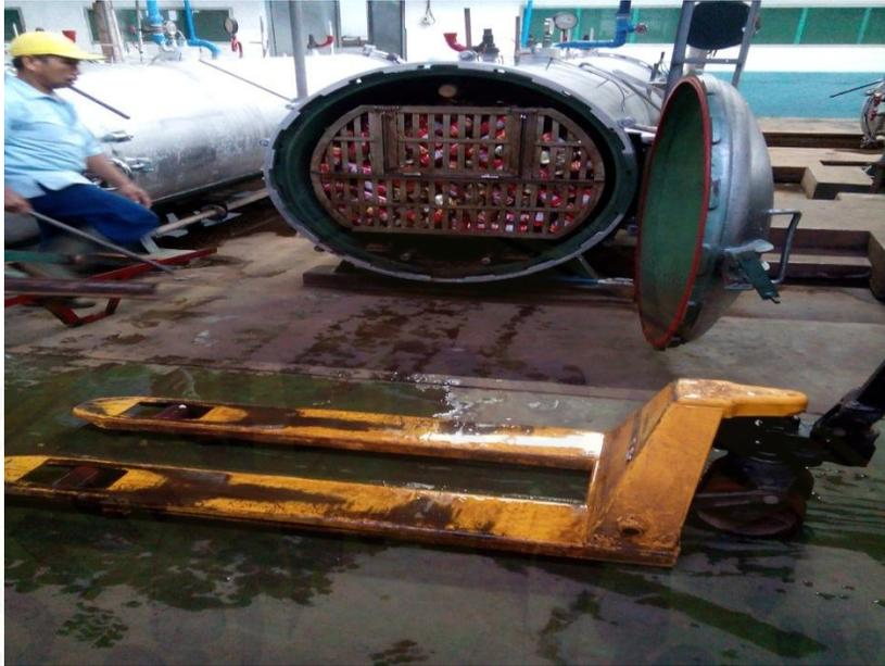
Gambar proses pemasukan sarden kaleng ke mesin *retort*
