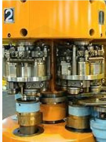
Gambar head dari mesin seamer
