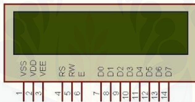
Gambar 2.6 Konfigurasi pin LCD
