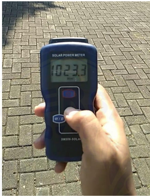
Lampiran 12. Pengambilan data radiasi matahari menggunakan pyranometer digital
