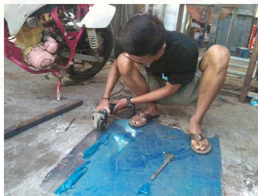
Gambar C.8 Proses penggerindaan plat untuk penampang adonan kerupuk
