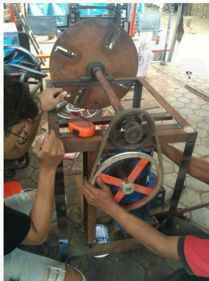
Gambar C.7 Proses pemasangan pulley
