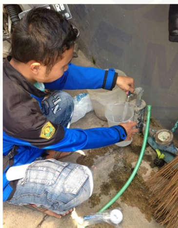
Gambar Q.17. Pengukuran Debit dengan Gelas Ukur
