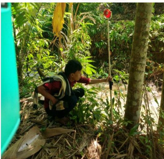
Pengambilan Titik Detail Tepi Sungai
