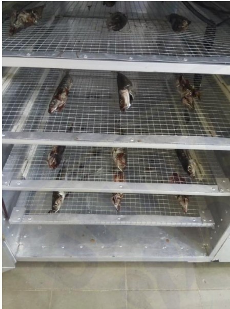
Proses pengeringan ikan dengan menggunakan alat pengering ikan
