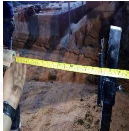
Pengukuran jarak penembakan dari nozzle ke spesimen
