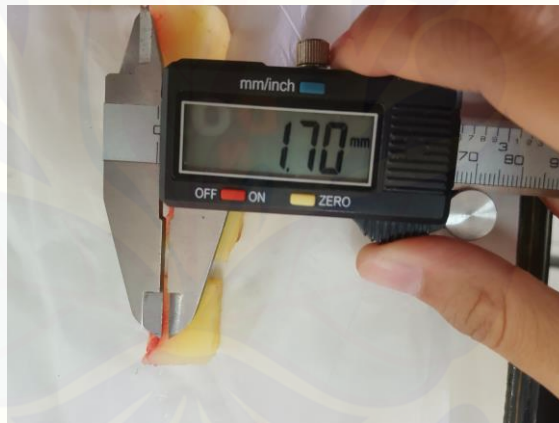
Gambar 3.4 Pengukuran panjang resapan warna pada bidang potong menggunakan jangka sorong
