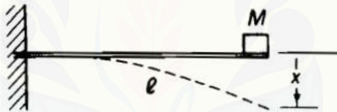
Gambar 2.9 Skema pembebanan batang kantilever (Sumber: Leckie dan Bello, 2009)
