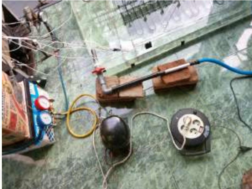
Gambar I.7 Proses Pemvakuman Mesin Pendingin Kulkas
